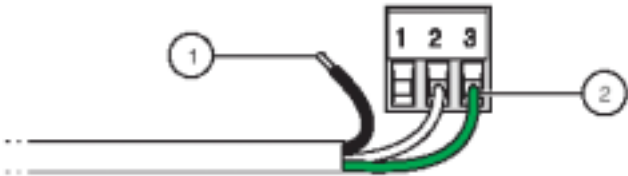
图 3-13 正确的导线制作及插入
